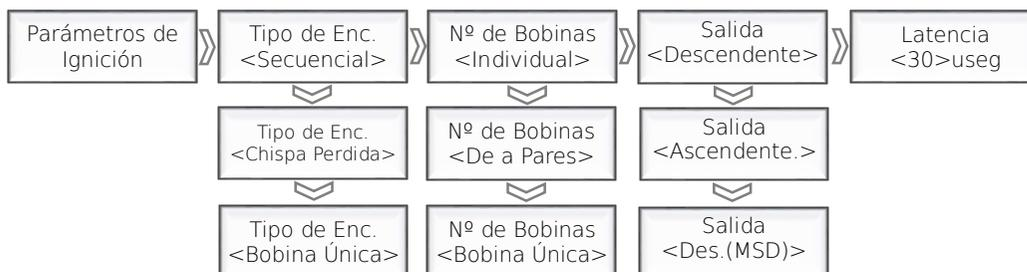
En esta configuración seleccionamos la forma en la cual actuara el sistema de encendido, pudiendo optar por encendido secuencial, de chispa perdida y bobina única con distribuidor. Además, es necesario especificar el tipo de salida, si se utilizara un módulo externo o una caja de encendido.
