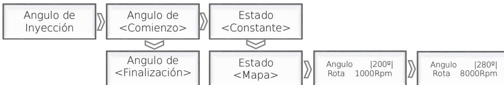
La funcionalidad del ángulo de inyección, es muy útil en los sistemas secuenciales de inyección de combustible, ya que se podrá optimizar la mezcla y el rendimiento del motor a diferentes regímenes ajustando el ángulo de inyección, generalmente se busca que el ángulo de inyección finaliza antes o durante la apertura de la válvula de admisión (entre 360 y 180 grados) cuando fuera posible.
