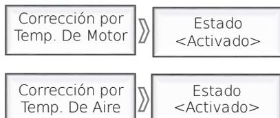
Las correcciones de temperatura son esenciales para el correcto funcionamiento del motor, se recomienda siempre que el estado sea Activado, al desactivarlas el sistema impondrá una temperatura de 85°C para el motor y 25°C para el Aire. Solo se recomienda desactivarlas ante una eventualidad con el sensor que no permita el correcto funcionamiento de la inyección.
