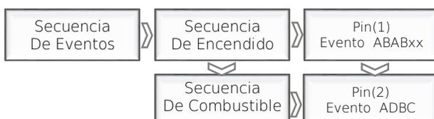
Podemos vincular los distintos pines de ignición e inyección a los distintos pines, dándonos una gran comodidad al realizar el cableado, o modificarlo si hubo un error sin tener la necesidad de re-cablear.
