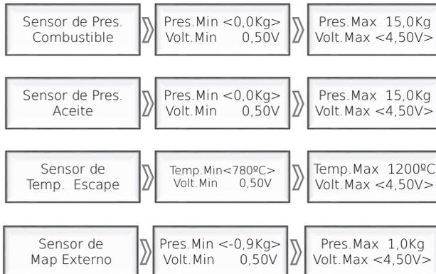
Las entradas auxiliares podrán ser configuradas según las características del sensor utilizado, recuerde que para utilizarlas es necesario vincular la entrada desde el menú de “entradas y salidas”, de esta manera la entrada auxiliar 3,4 y 5 podrán funcionar como sensor de presión de combustible, aceite o temperatura de escape.
