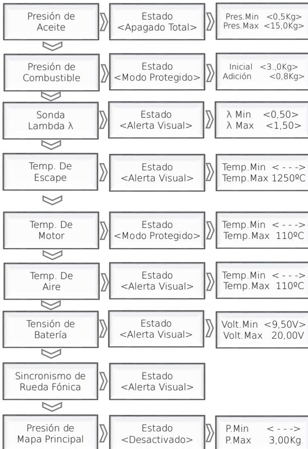
Todas las alertas y protecciones serán evaluadas 2 segundos después del arranque del motor, y es necesario que se mantenga la condición de disparo por al menos 0,3 segundos antes de que se dispare una alerta.
