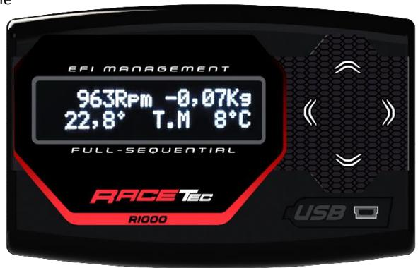
Posee computadora de abordo donde podrá visualizar una gran cantidad de valores para su análisis, como también a través del software de PC en tiempo real, usted podrá acceder a los mapas y ajustes necesarios para la calibración del motor.
