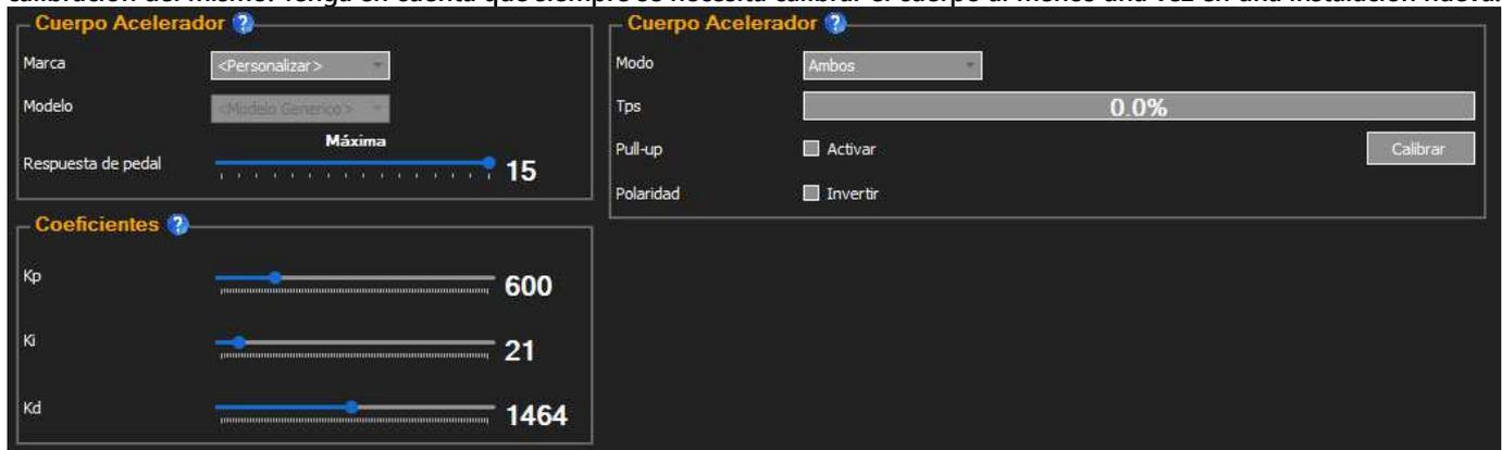
El menú del Cuerpo de Acelerador se divide en tres áreas. Primero, seleccione la Marca y Modelo del cuerpo; si no está disponible, ajuste los coeficientes para un movimiento suave y preciso al presionar el pedal. Si necesita ayuda, contacte al soporte técnico.
